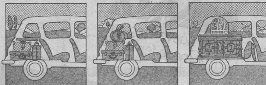
La capacidad es una de las grandes ventajas del Renault 4. Un maletero de suelo plano, sin obstáculos para la carga, que ofrece tres alternativas de uso: normal (295 dm<sup>3</sup>), con bandeja plegada (para llevar objetos altos), y con el asiento trasero abatido (1.185 dm<sup>3</sup>).
