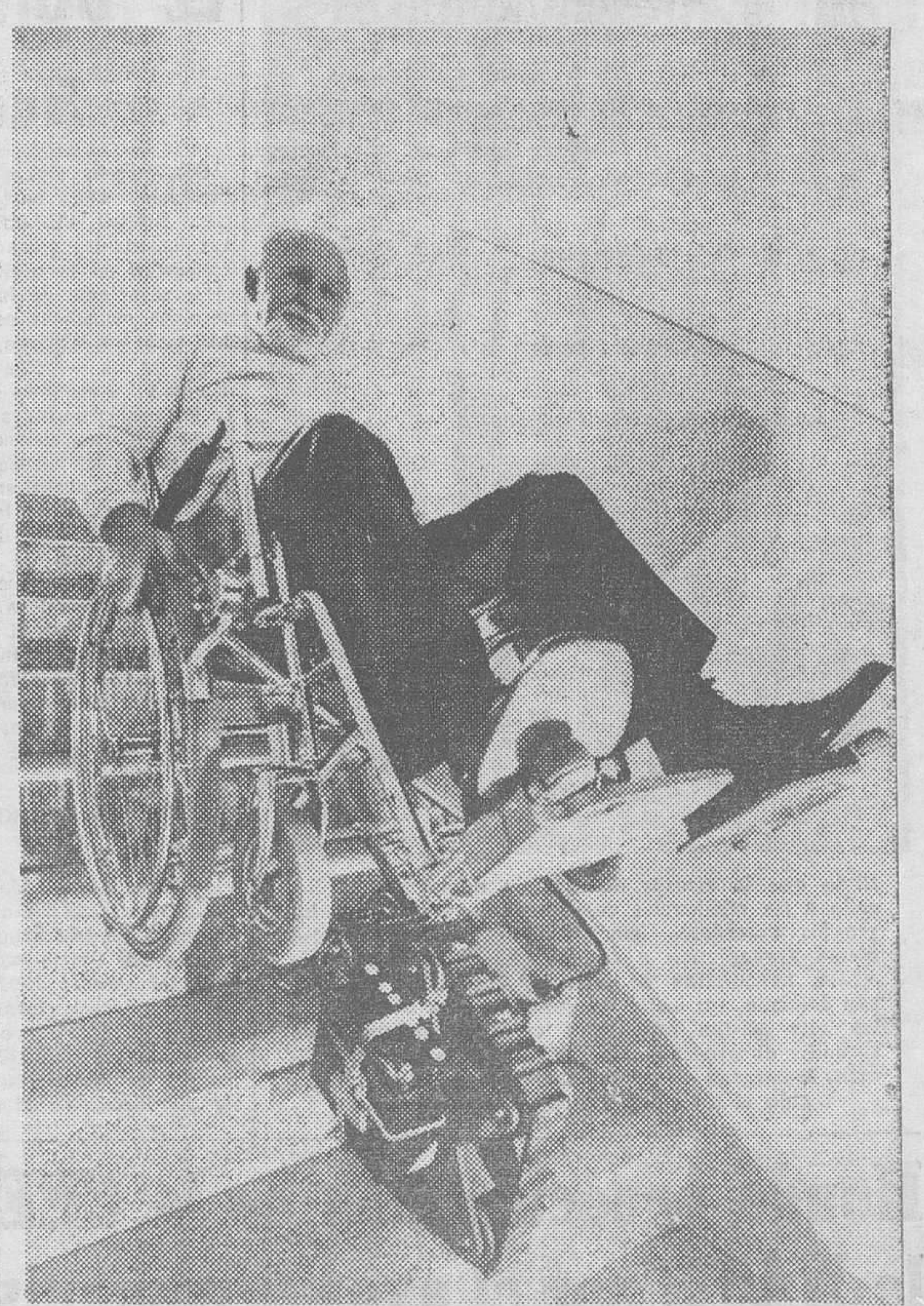
Hamburgo (DaD). — El sillón de ruedas de la fotografía está dotado de un dispositivo especial que permite a su usuario subir y bajar escaleras cómodamente y sin peligro alguno. Es invención del ingeniero industrial Werner Last, de Hamburgo (República Federal de Alemania), quien lo construyó para su esposa, inválida y entretanto fallecida. En la fotografía, el señor Last realiza una demostración de su invento ante la cámara. Lo esencial y revolucionario del nuevo sillón es la quinta rueda de apoyo, en forma pentagonal y dotada de una cadena elástica, gracias a la cual el sillón se mantiene en posición horizontal al tiempo que sube o baja los escalones. Una vez en la calle o en la vivienda, la quinta rueda desaparece bajo el sillón. El dispositivo, que funciona eléctricamente, puede ser montado en cualquier sillón de ruedas. La patente ha sido registrada ya en varios países extranjeros. — (Foto DAD).
