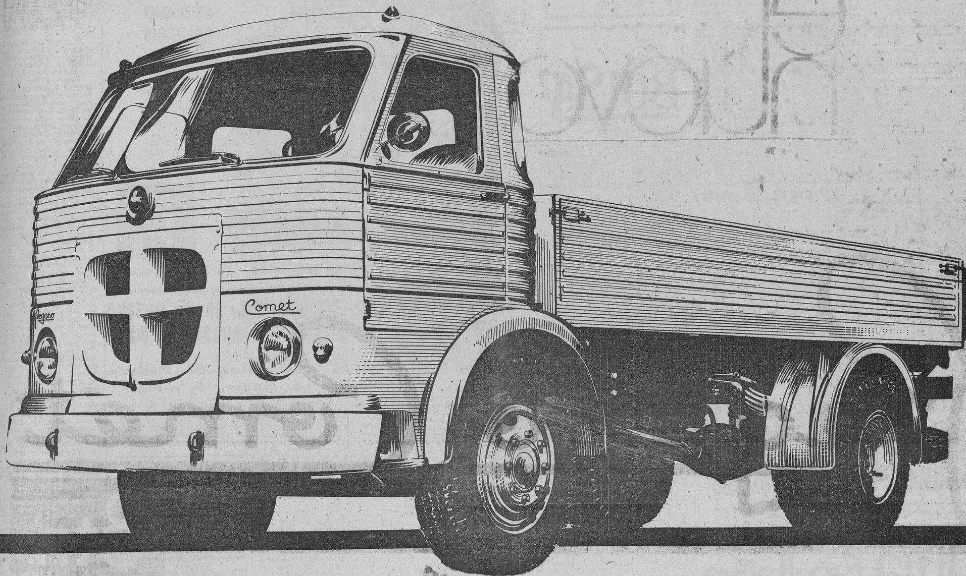
4.º Eje anterior de sección doble T, estampado en acero aleado y tratado térmicamente.
