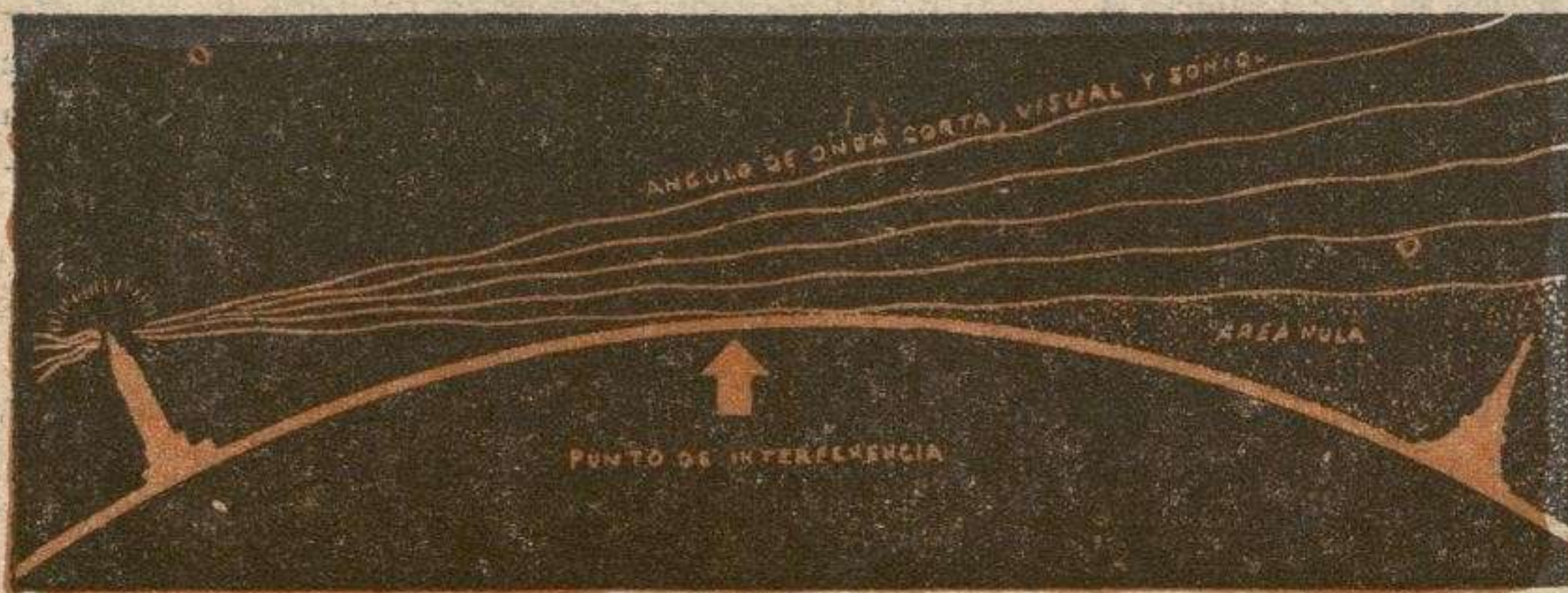
Las ondas ultra cortas lanzadas al horizonte llevan las señales de televisión en una línea recta. El radio de la «broadcasting» depende de la altura de la mayor o menor antena utilizada.
