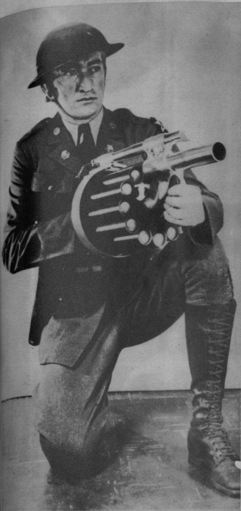
ESTE RARO instrumento es una ametralladora de 37 mm., construida por C. J. Manville, de Pontiac (Michigan). Puede lanzar 12 proyectiles de gas o 12 señales para paracaidistas. Los disparos se hacen en un tiempo no superior a los 5 segundos. La ametralladora pesa 18 libras. (F. W.)
