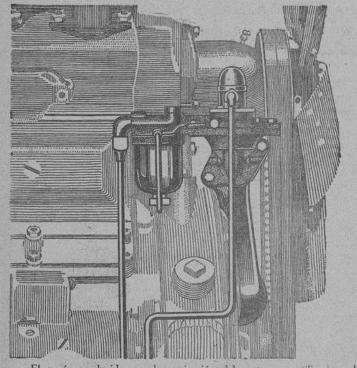
El vacío producido por la aspiración del motor, se utiliza en el Packard actual para el engrase automático del chasis, en vez de utilizarlo para la alimentación de gasolina. Esta llega al motor por la succión de una bomba aspirante que puede verse junto al ventilador.
