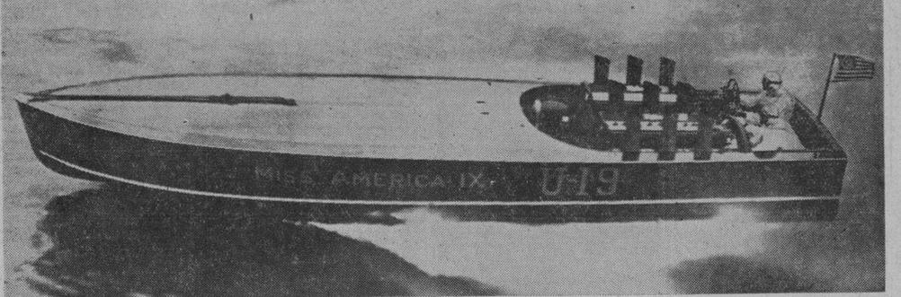
El «Miss América IX», que acaba de romper dos records mundiales de velocidad manejado por Gard Wood. Va impulsado por dos motores Packard de 1100 HP.
