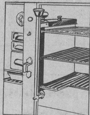
Observe cómo queda colocado el tanque dentro del refrigerador, sin restarle capacidad para los alimentos.
