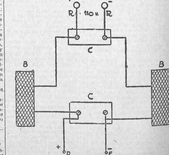
Esquema de un filtro para tensión de placa en corriente continua: B, Bobinas de nido de abejas, 400 vueltas; C, Condensadores fijos de cuatro microfaradín; P, A placa; F, A filamento; R, A la red del alumbrado
