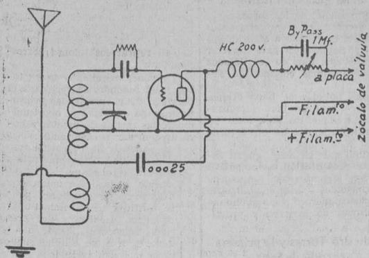
He aquí el esquema del receptor que permite escuchar la extracorta con cualquier aparato.
