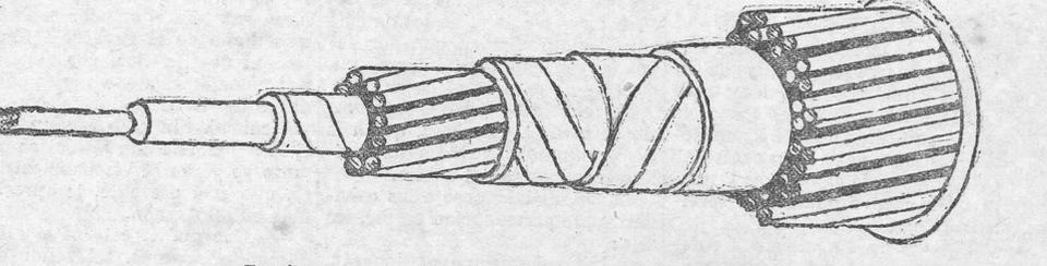
Envoltura y conductores de cobre de un cable de amarre
