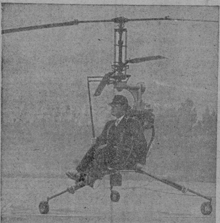
Helicóptero personal que permite alcanzar una velocidad de crucero de 65 a 90 kilómetros por hora, transportando un peso de 75 kilogramos. — (Galpe)
