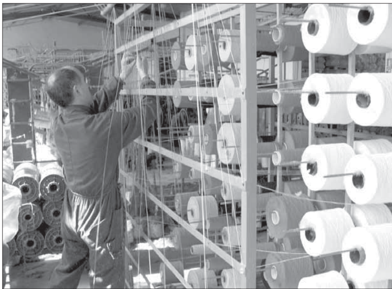
Tendedera de alimentación de una "twister" en Hilaturas y Cordelería Poza
