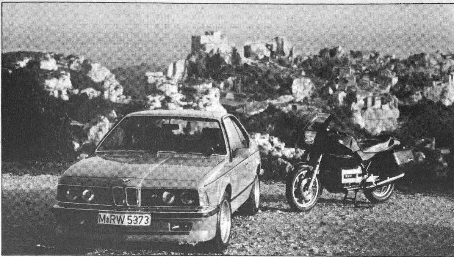
Modelo Coupé BMW 635 csi, que ahora, con su nuevo propulsor de seis cilindros en línea y cuatro válvulas por cilindro, logra una potencia de 286 CV. y velocidad de 255 km/h. A su lado, la nueva y excepcional motocicleta BMW K 100 RT.
