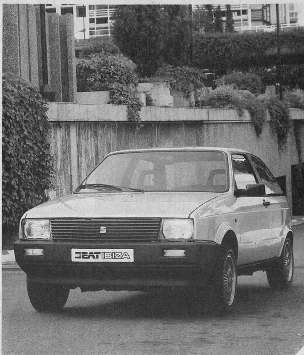
El diseño de Giorgio Giugiaro personaliza las formas y el moderno estilo del Seat Ibiza, en el que se ha logrado un coeficiente de penetración al aire de 0,36 Cx.
