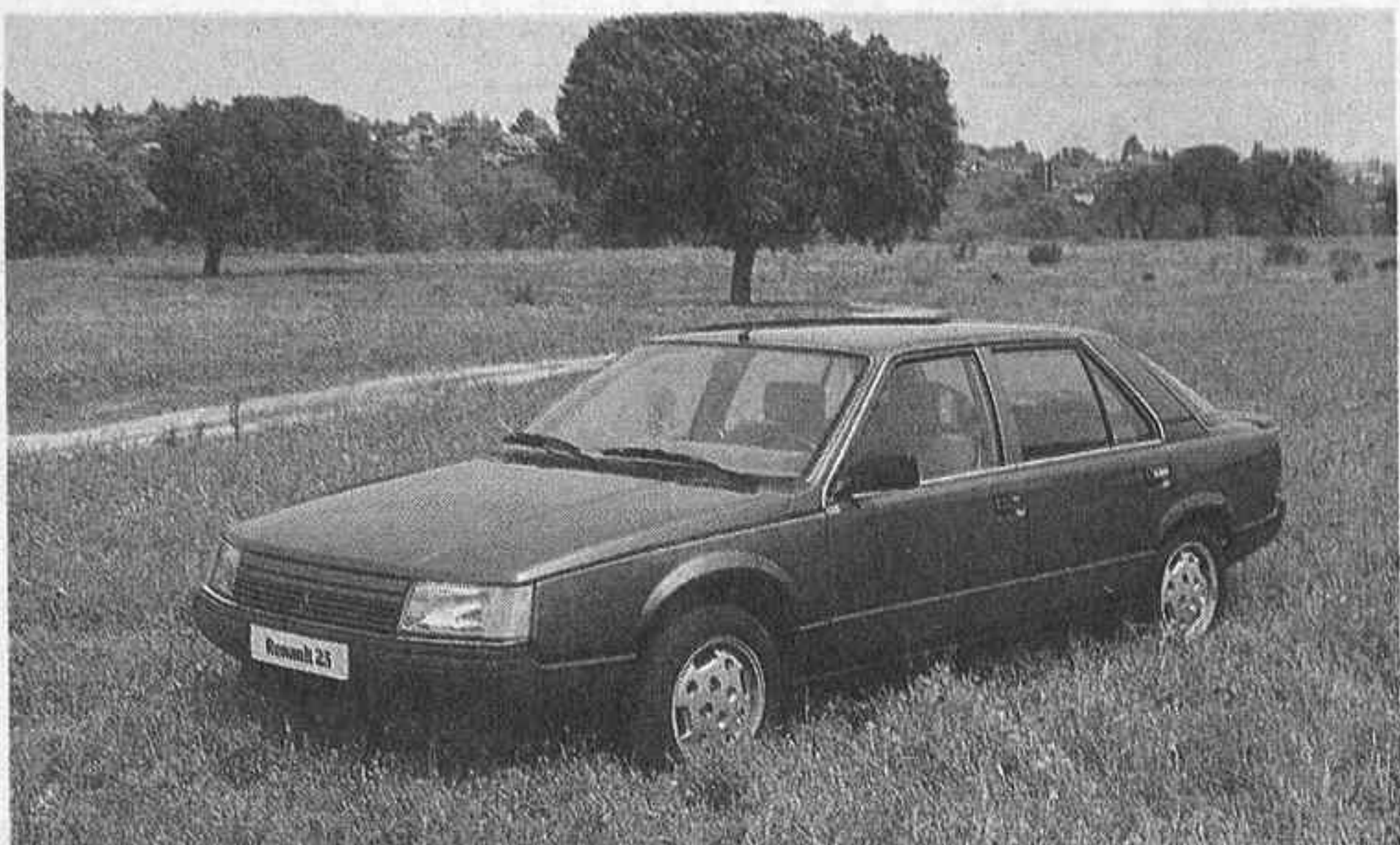
Nuevo Renault-25 comercializado en nuestro mercado interior con motorizaciones de gasolina dos litros, 2.2 gasolina inyección, Diesel 2.068 c.c. con 64 CV. y la versión Diesel turbo con potencia máxima de 85 CV. y velocidad punta de 162 km/h.
