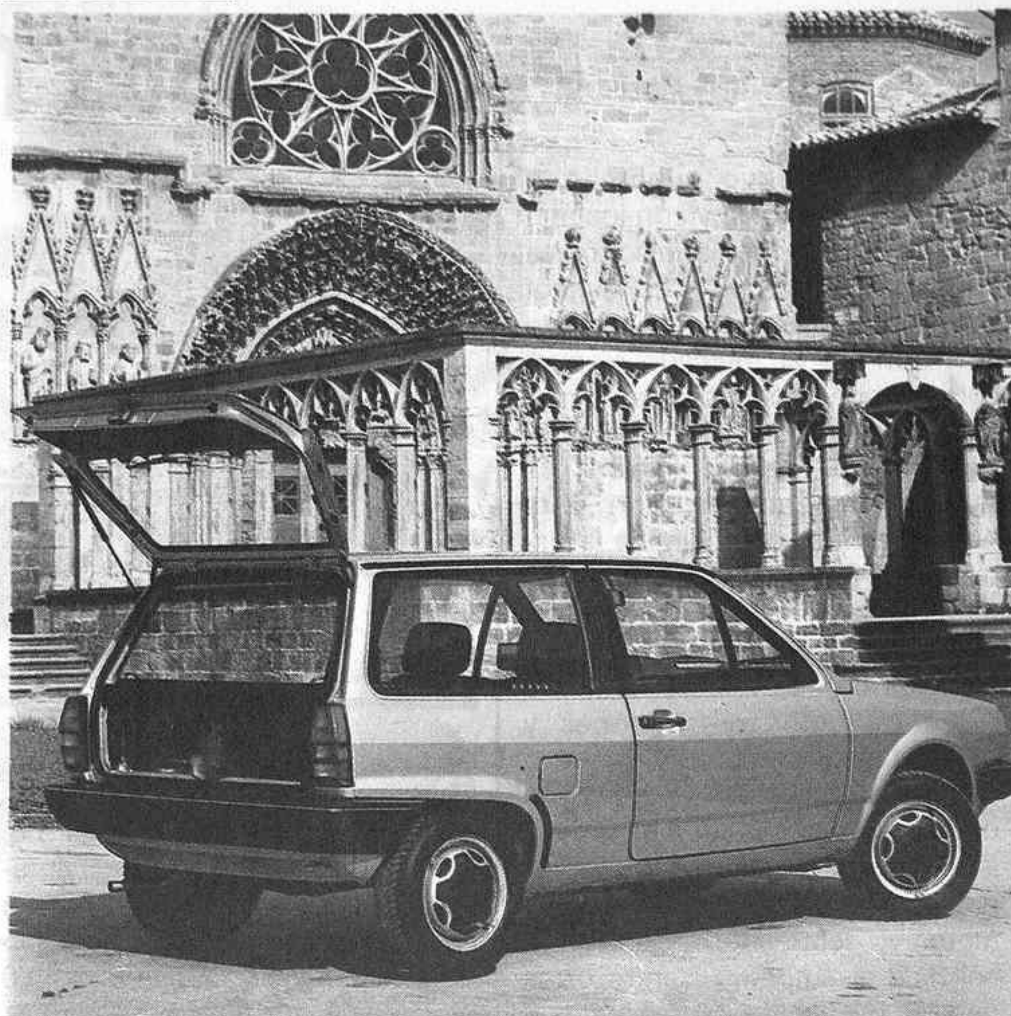
La carrocería, de dos puertas laterales, cuenta con un amplio portón trasero de apertura total que facilita un cómodo acceso al portaequipajes o al compartimiento de carga con los asientos traseros abatidos.
