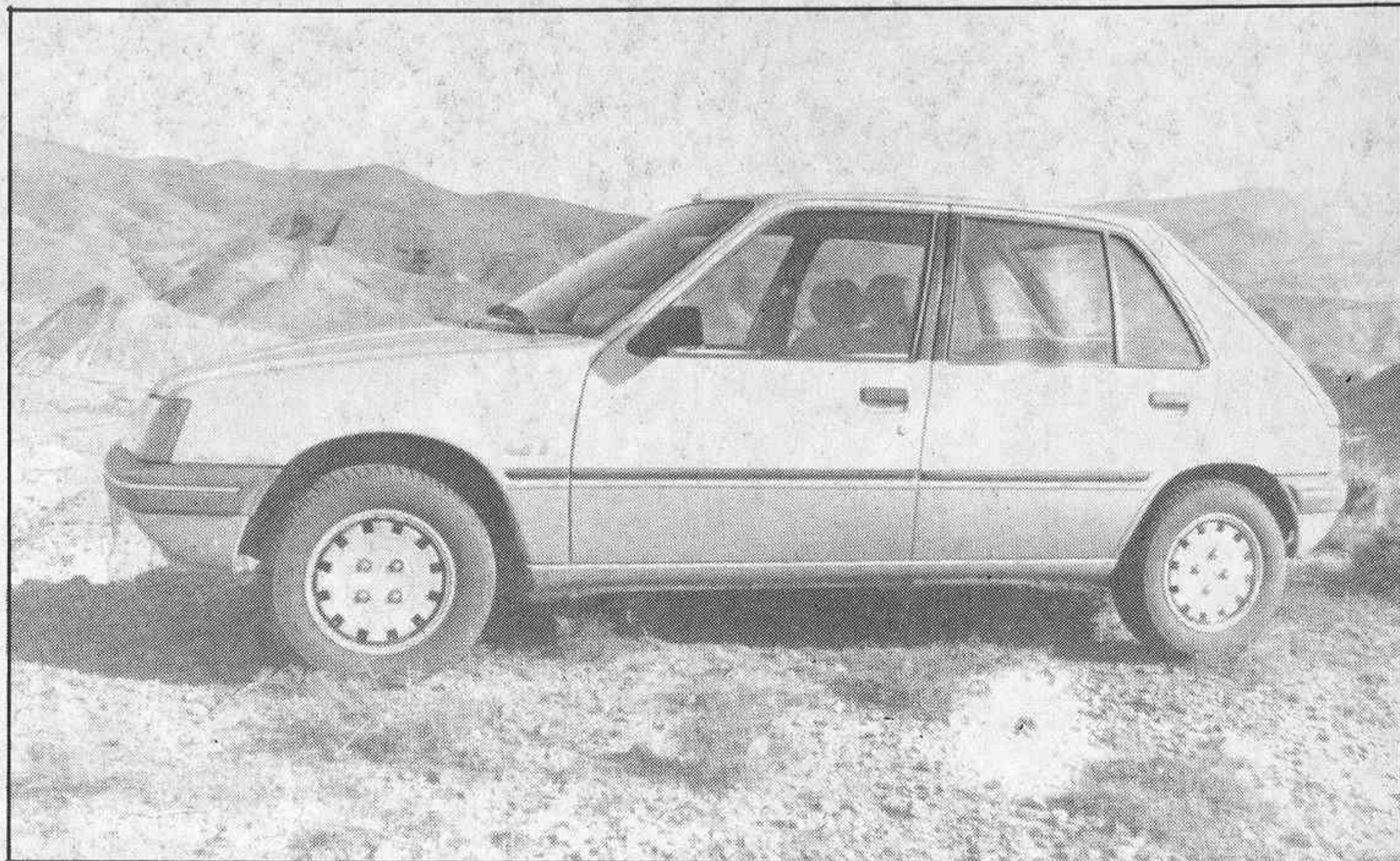
El Peugeot 205 GT corresponde al de mayor cilindrada de la serie que se fabrica en España. Equipa el conocido motor Simca de 1.442 c.c., que le proporciona unas prestaciones de 172 km/h.
