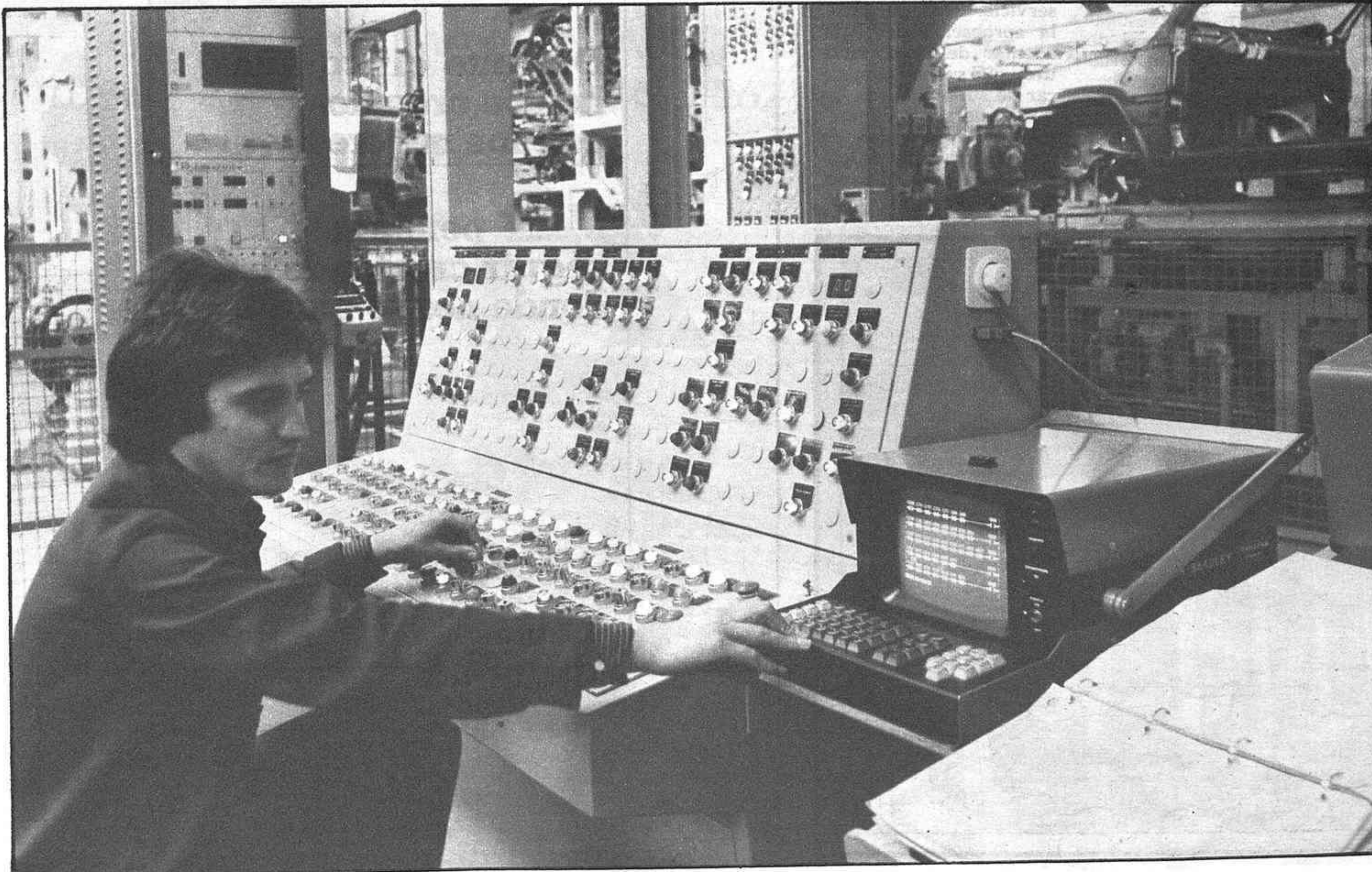
Control por circuito cerrado de televisión del funcionamiento de todo el proceso de soldadura automática de la carrocería del Ronda, nuevo modelo Seat, desarrollado en su centro técnico de Martorell
