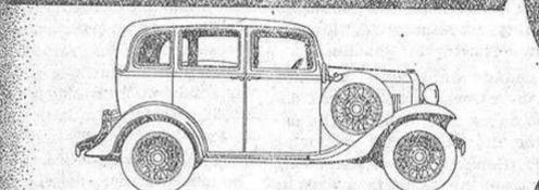
**Sedán 4 cilindros, 4 puertas.** Distancia entre ejes 2.45 mts. motor de 9 H.P. fiscales (23 H.P. al freno)... Al igual que en los demás modelos el chasis está suspendido por 4 ballestas semi-elípticas paralelas al bastidor, y lleva 4 amortiguadores hidráulicos. El equipo comprende: para choques delante y atrás, 5 ruedas de alambre - la de repuesto en el guardabarro derecho - con neumáticos balón 4.75 x 17, portamaletas. Ptas. **8.695**
