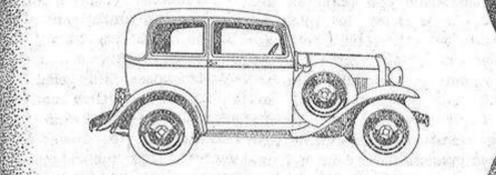
**Sedán 4 cilindros, 2 puertas.** El chasis de 2.29 mts. entre ejes; está dotado de un motor de 9 H.P. fiscales (fuerza efectiva: 23 H.P.). Como en todos los modelos, el cambio de marchas tiene 4 velocidades hacia adelante. El equipo comprende para choques delante y atrás, cinco ruedas de disco - la de repuesto en un pozo en el guardabarro derecho - con neumáticos balón 4.50 x 17 y portamaletas. Ptas. **7.550**
