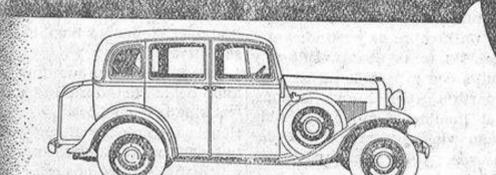
**Sedán de Lujo, 6 cilindros, 4 puertas.** Chasis de 2.54 mts. entre ejes... Motor de 33 H.P. efectivos (14 H.P. de matrícula)... Profusión de metal cromoplataado... reloj... encendedor... visera quitasol... dos almohadillas... dos limpia-parabrisas... dos bocinas... maleta con 2 maletines... ventilación contra-aire... Seis ruedas de disco con neumáticos 5.00 x 17 balón... fundas para las ruedas de repuesto. Ptas. **10.950**
