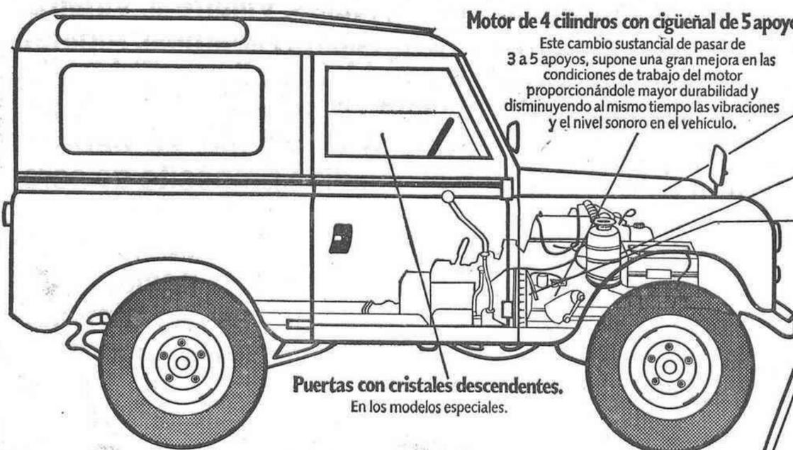
Motor de 4 cilindros con cigüeñal de 5 apoyos.
