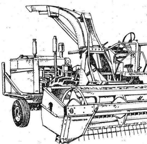
**Recogedora Picadora de corte exacto autopropulsada.**
