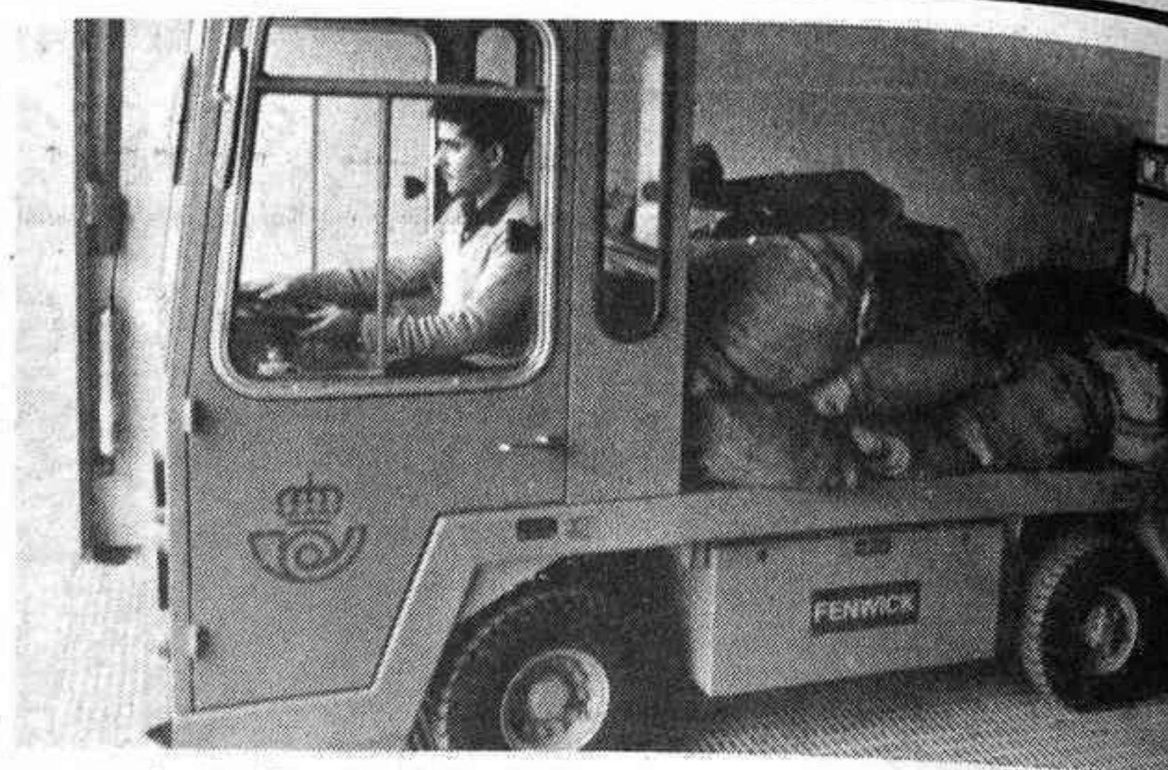
La mecanización del servicio ha llegado al transporte: carretilla de tracción eléctrica que se utiliza en el pabellón postal.
