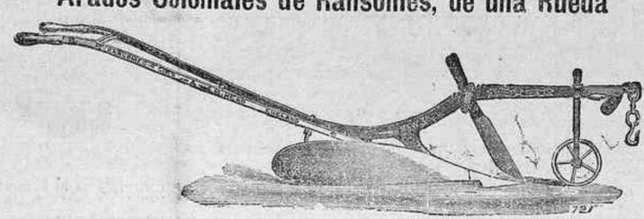
Estos arados combinan todas las ventajas de los mejores arados ingleses. Son muy fuertes en todas sus partes; el timón, el armazón y la manecra del lado de la tierra son de hierro forjado en una sola pieza, dándoles de este modo gran resistencia y evitando el empleo de tornillos. La vertedera es de acero y la reja de hierro fundido ó de hierro forjado acerado, según se prefiera. Las rejas para el arado N.S.W.O. están marcadas R.H.A., y las para los arados N.S.W. 1, 2 y 3, R.N.F.
