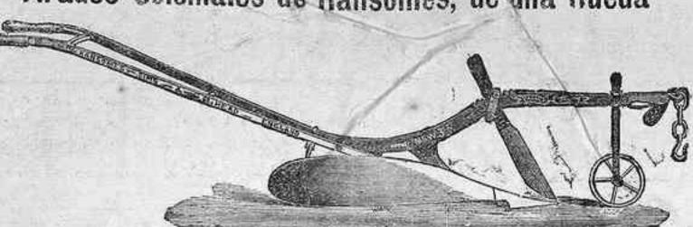
Estos arados combinan todas las ventajas de los mejores arados ingleses. Son muy uertes en todas sus partes; el timón, el armazón y la mancera del lado de la tierra son de hierro forjado en una sola pieza, dándoles de este modo gran resistencia y evitando el empleo de tornillos. La verte era es de acero y la reja de hierro fundido o de hierro forjado acerado, según se prefiera. Las rejas para el arado N.S W.o, están marcadas R.H.A.,
