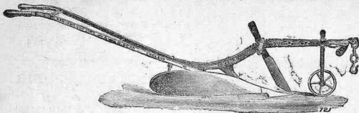
Estos arados combinan todas las ventajas de los mejores arados ingleses. Son muy fuertes en todas sus partes; el timón, el armazón y la manera del lado de la tierra son de hierro forjado en una sola pieza, dándoles de este modo gran resistencia y evitando el empleo de tornillos. La vertedera es de acero y la reja de hierro fundido ó de hierro forjado acerado, según se prefiera. Las rejas para el arado N.S.W.o, están marcadas R.H.A., y las para los arados N.S.W. 1, 2 y 3, R.N.F.
