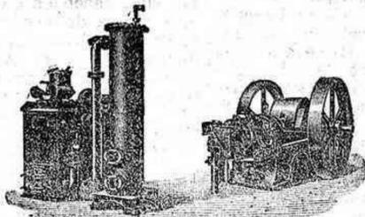
Motor y Gasógeno (Gas pobre)
