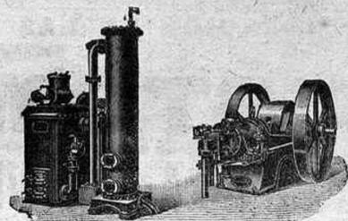
Motor y Gasógeno (Gas pobre)
