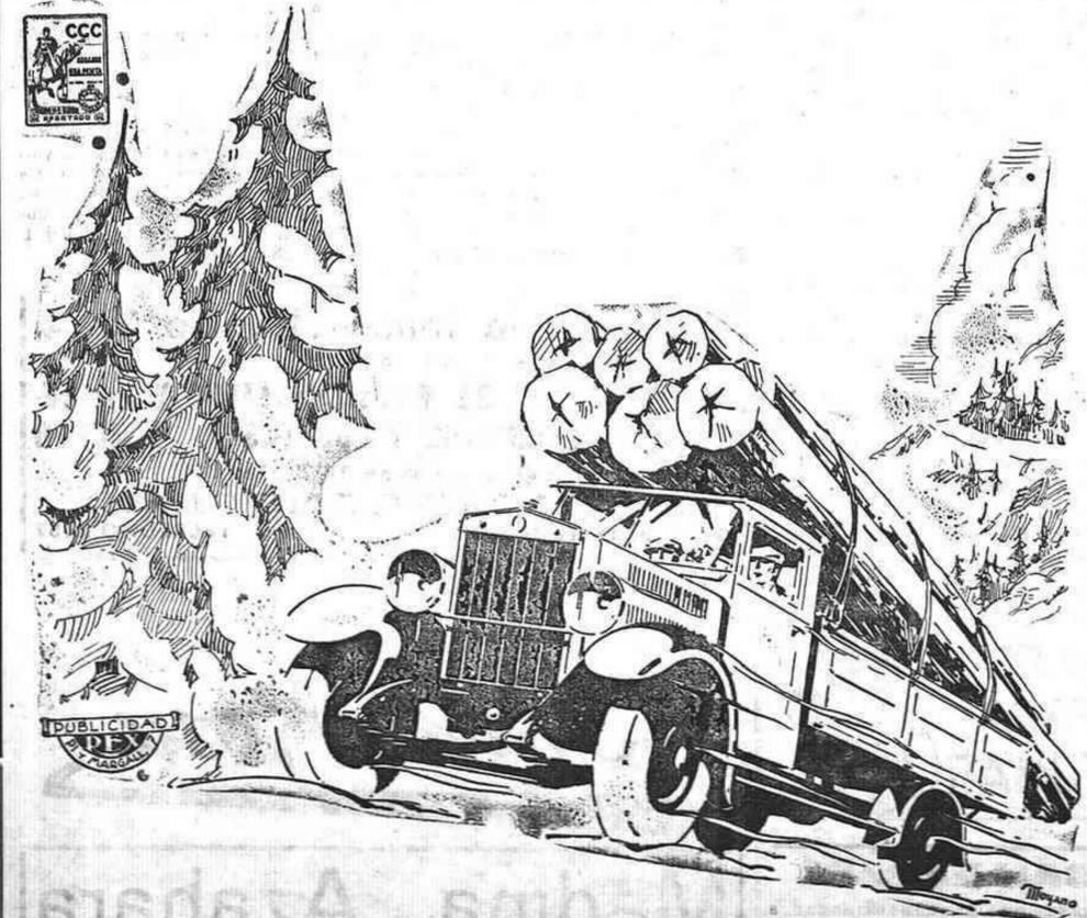
Cigüeñal montado sobre siete soportes, grupo cilindros al níquelcromo, frenos independientes, embrague a cuatro discos conducidos. Potencia del motor al freno, 42 HP. Potencia Fiscal, 17 HP. Largo del bastidor, 4'64 m. Espacio para la carrocería, 3'38 m. Gomas sencillas posteriores, 32x6. Rueda de disco. Completamente equipado con guardabarros anterior y posterior, estribos, faldilla, portaruedas.
