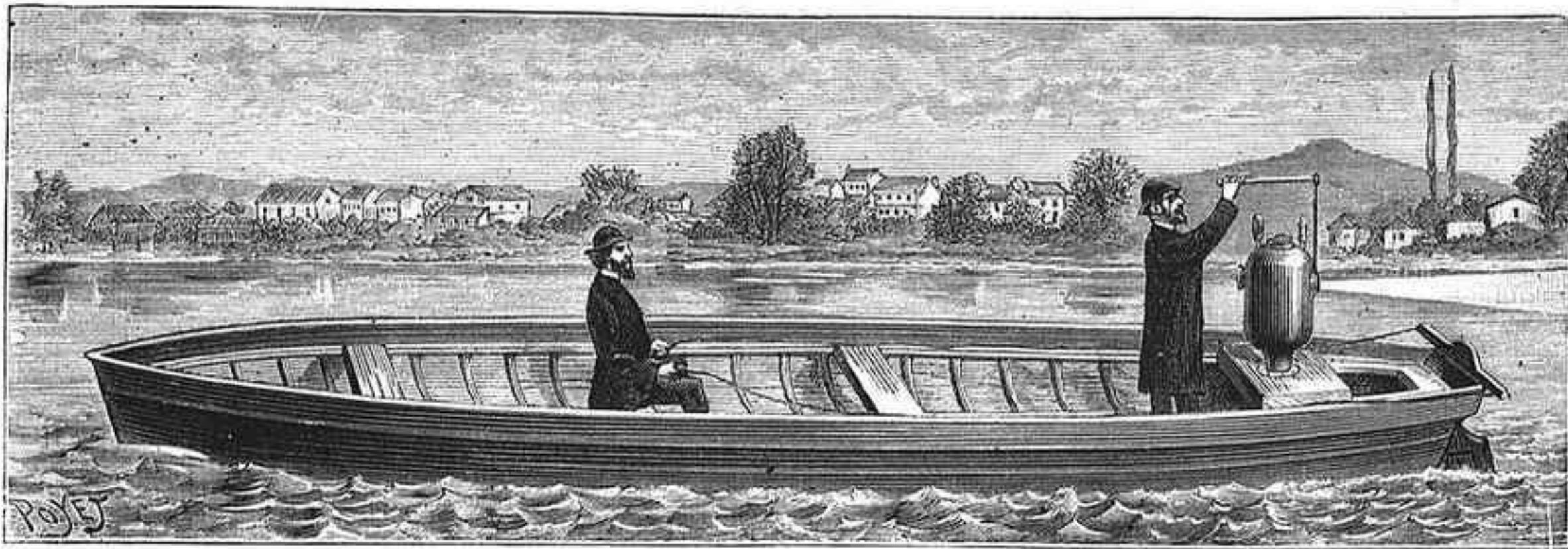
Fig. 1.—Primer modelo del propulsor de reacción de MM. J. Buisson y A. Ciurcu
