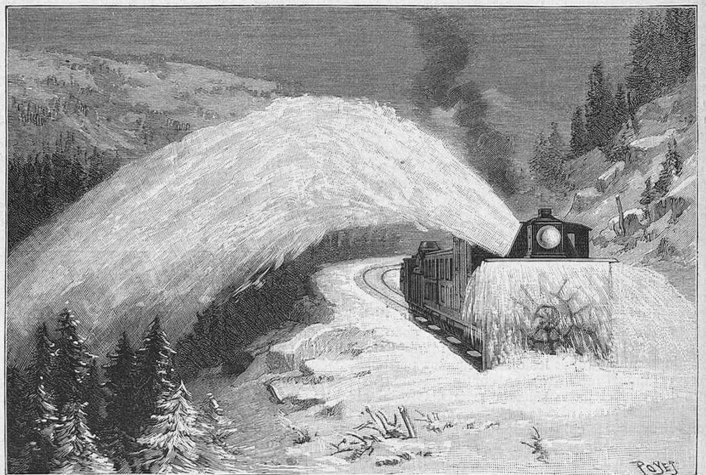
Fig. 3. La quitanieve Rotary funcionando. (De una fotografía instantánea.)
