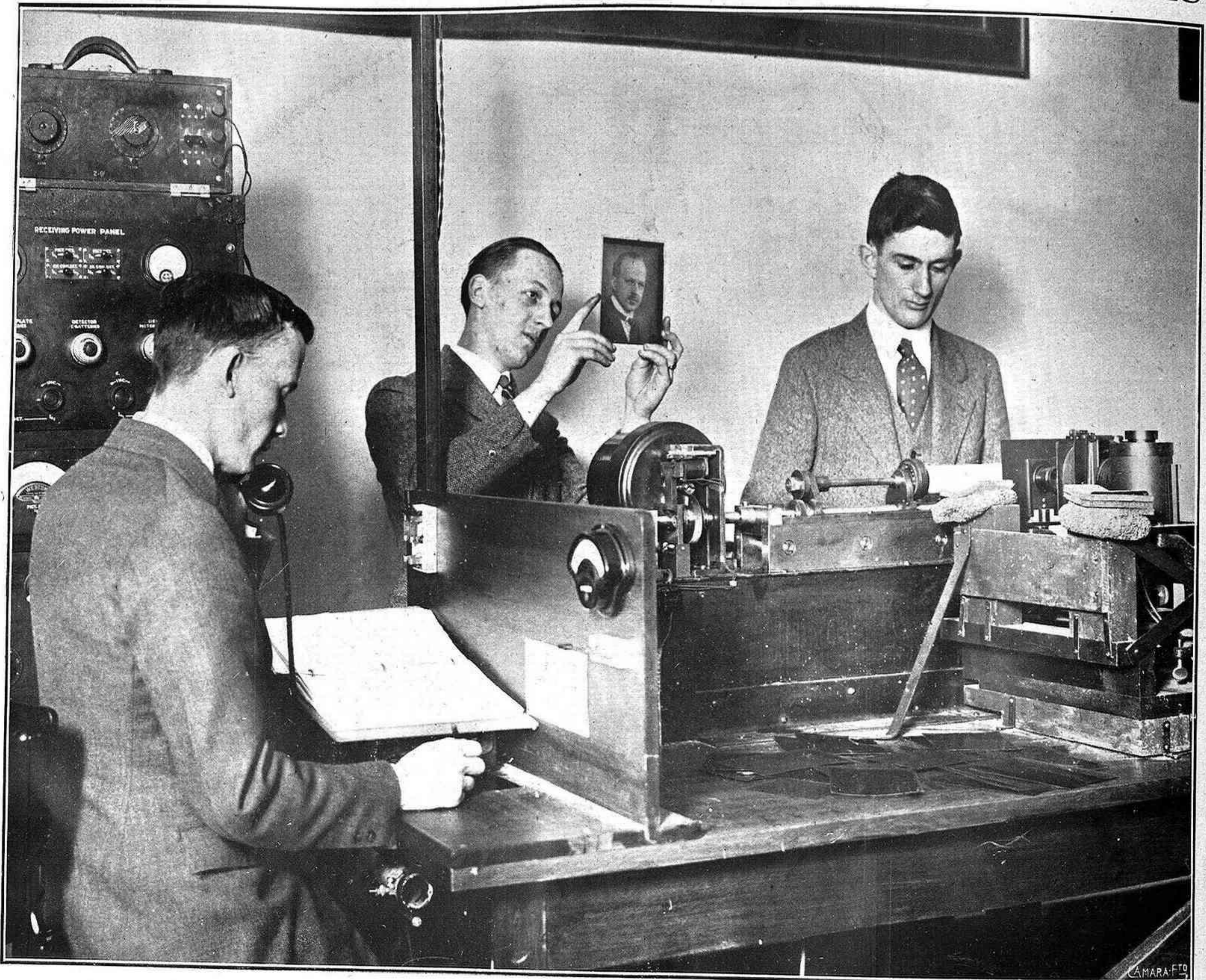
Aparato receptor empleado en el nuevo sistema de transmisión de fotografías por teléfono ordinario. Uno de los operadores examinando la primera fotografía transmitida
