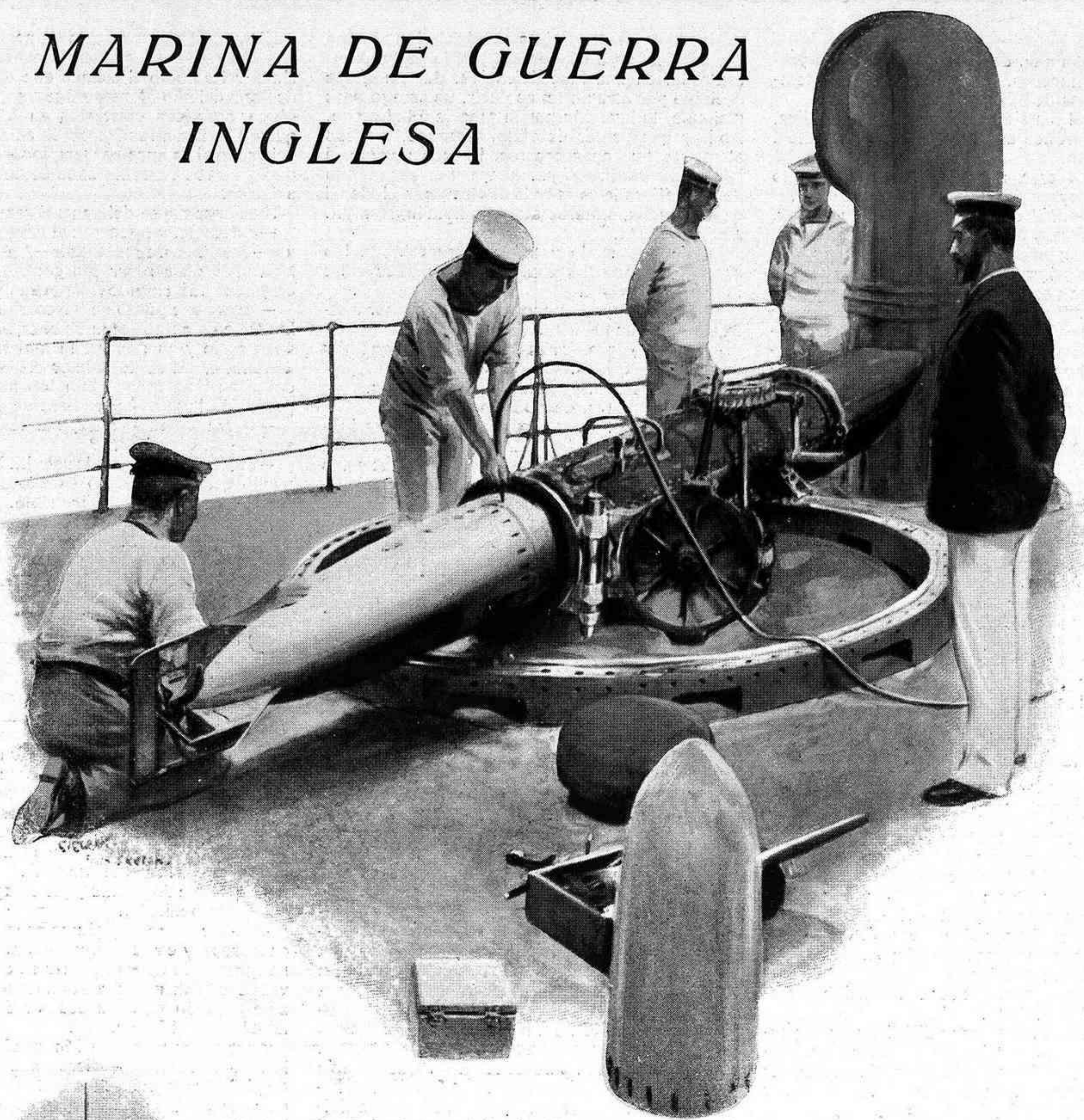
Carga de un torpedo con aire comprimido
