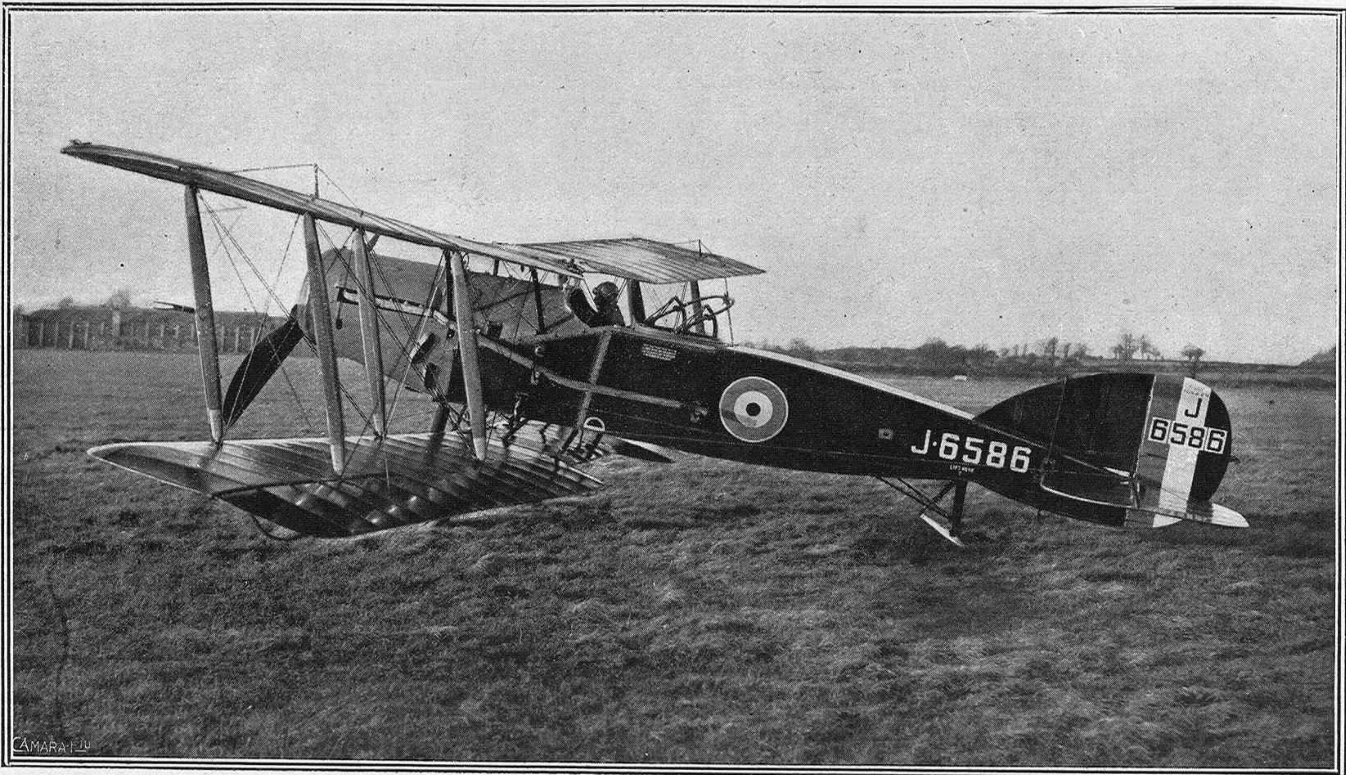
Biplano "Bristol", con motor Hispano-Suiza de 300 HP., modelo de los adquiridos por el Gobierno español para el Ejército á la Compañía Española de Navegación Aérea, S. A., de San Sebastián, representante en nuestro país de la importante Casa inglesa
