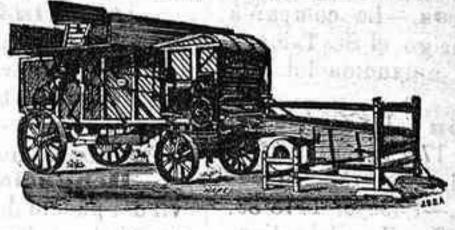
TRILLADORAS DE VAPOR CON APARATO PARA CORTAR Y Mª CHACAR LA PAJA.
