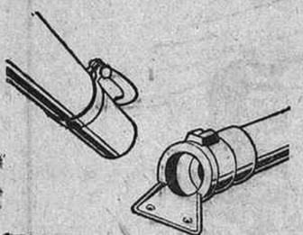
Todos los tubos y conexiones que RIEGO WRIGHT, S. A. suministra, están fabricados en aleación de aluminio, que es un material de mucha duración y tiene poco peso. Y otra ventaja de WRIGHT la constituye el sistema de acoplamiento de tubos. Se pueden conectar y desconectar, sin necesidad de caminar hasta el empalme.
