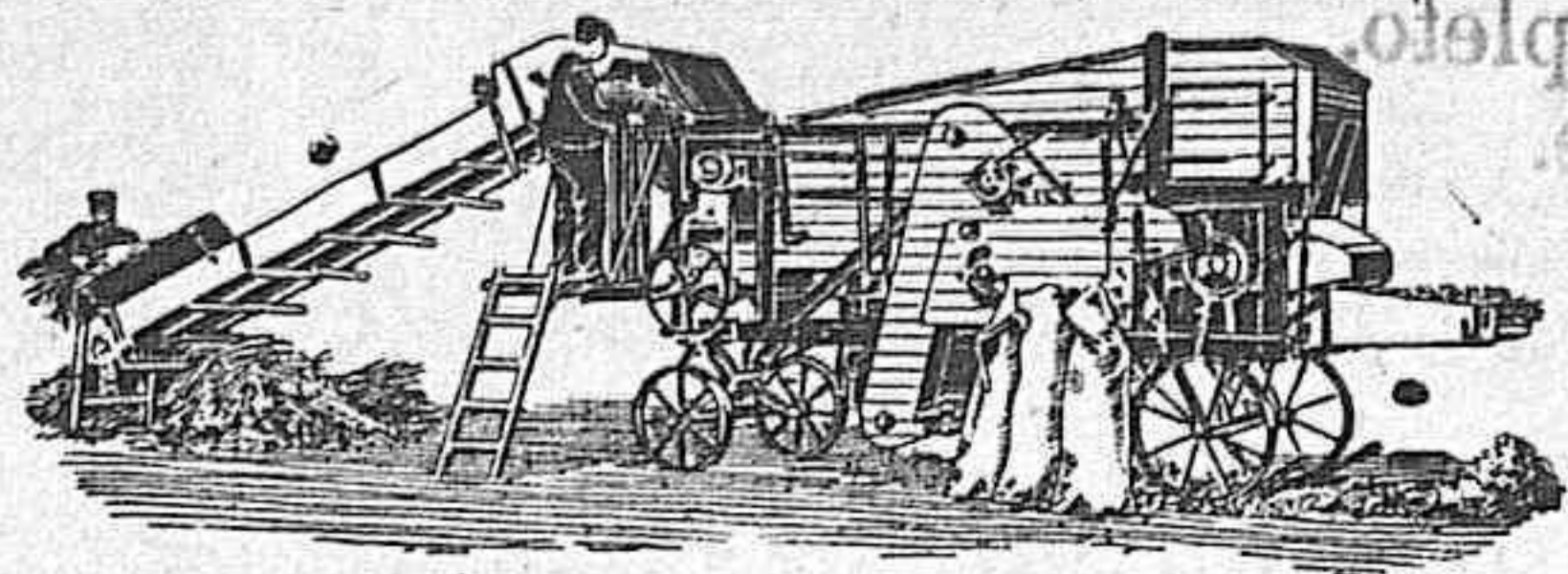
Trilladora «Triunfo Chica» con elevador de mies. Rendimiento diario de 90 a 120 fanegas de trigo diarias, según granazón.
