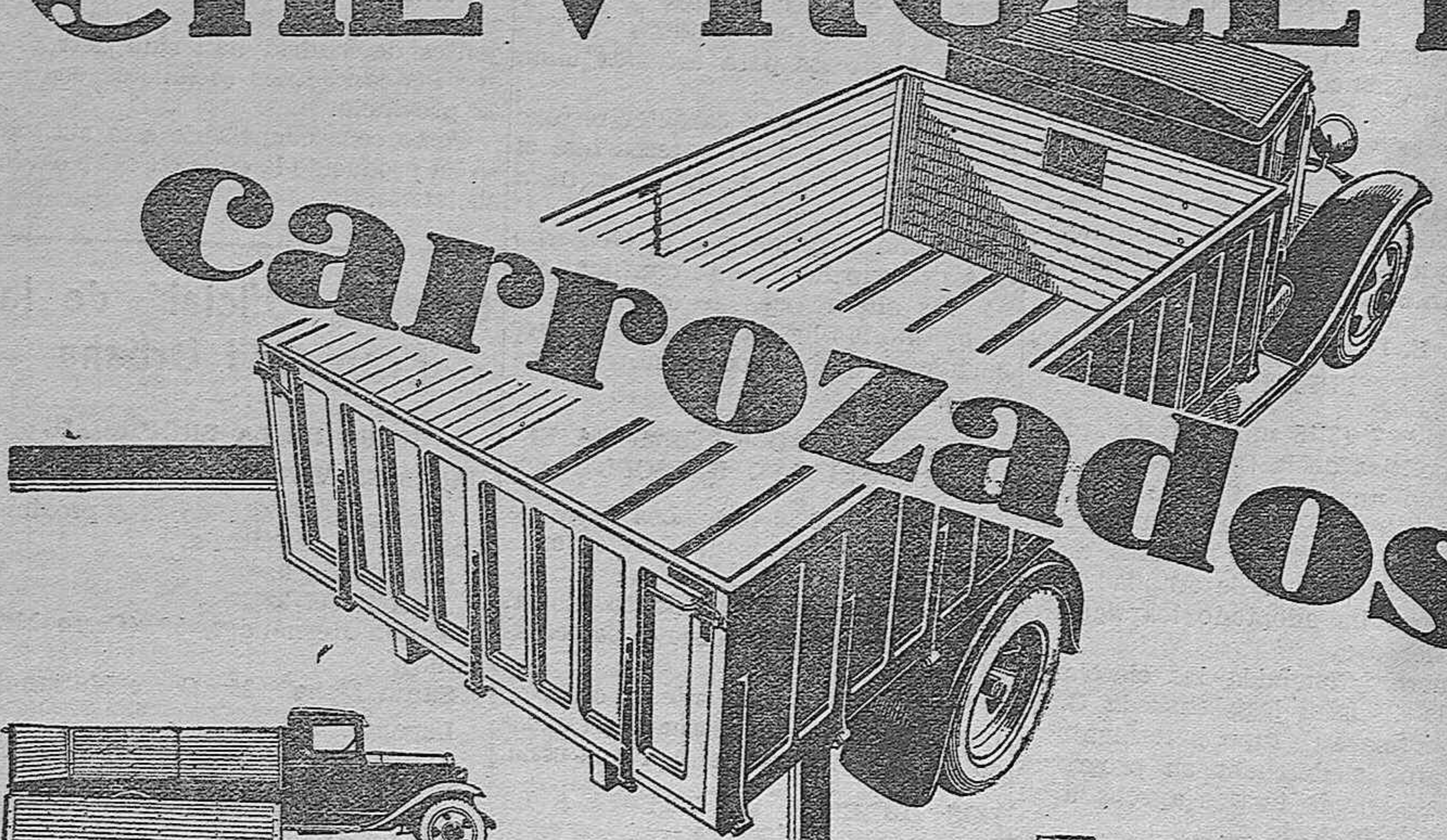
Carrocería de caja con costeros abatibles. Se ofrece en dos modelos con costeros de 80 ó 60 cm. de alto, y con o sin toldo.
