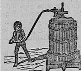
Prensa Hércules, para uvas sistema de palanca múltiple reforzada. Pisadoras, Separadoras y estrujaderas de uva.
