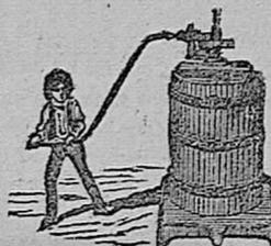
Prensa Hércules, para uvas sistema de palanca múltiple reforzada. Pisadoras, Separadoras y es-trujaderas de uva.
