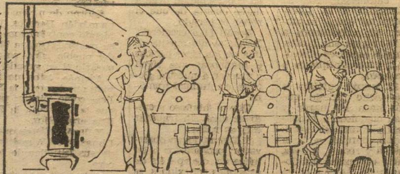
Los sistemas de calefacción por convección obligan a calentar **todo el aire de un local** con gran irregularidad y lentitud y con un considerable derroche de energía.
