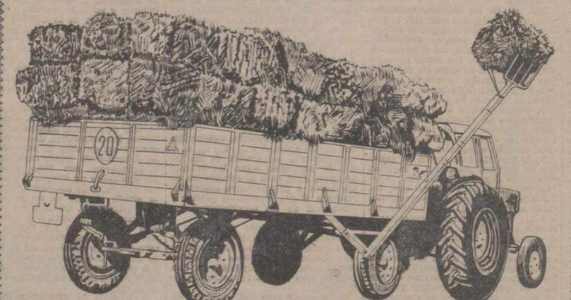
Totalmente hidráulico y automático, adaptable a los brazos del tractor, remolque, camión, o plataforma. Potencia de elevación con brazo plegado 140 Kgm. con el brazo desplegado al máximo permite cargar de 60 a 70 Kgm. Carga sobradamente fardos de paja o alfalfa, elevando a la altura de 7 a 8 metros sobre camión o remolque.
