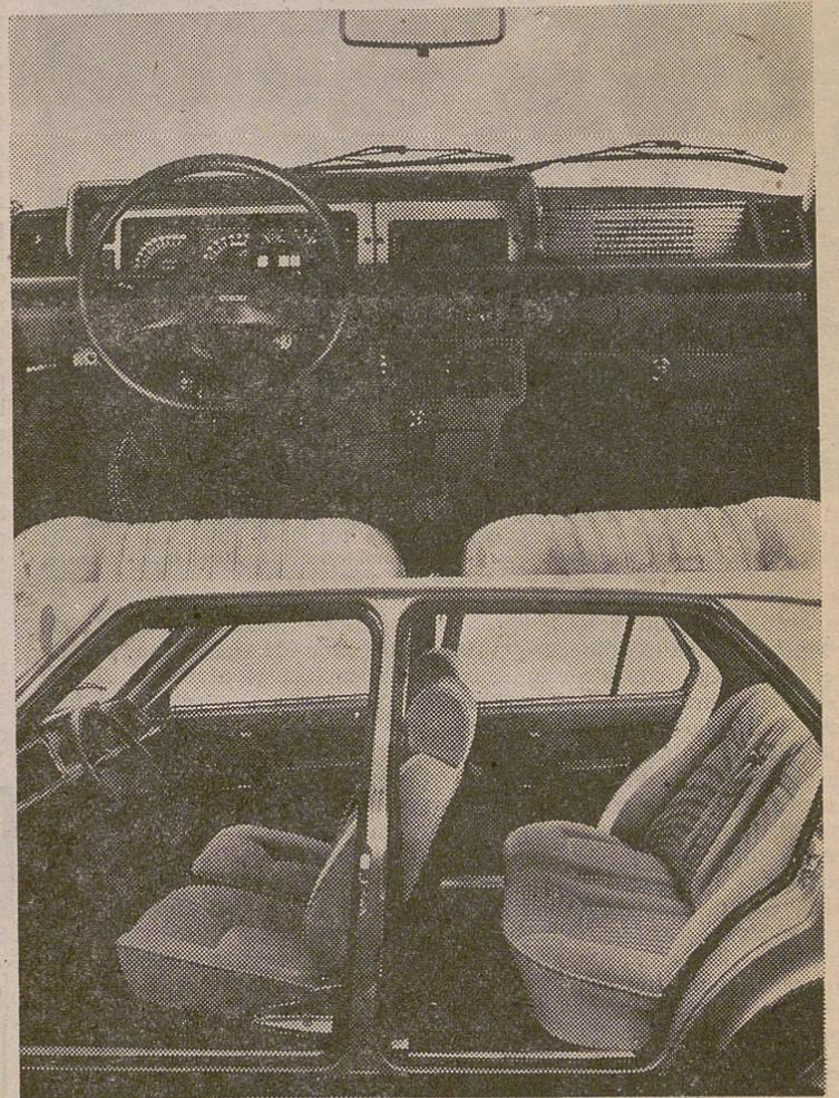
FOTO SUPERIOR.—El tablero de instrumentos del nuevo SEAT 132 ha sido diseñado por completo. El volante, de tacto esponjoso y radios en "V" invertida, es regulable en altura. Los instrumentos de control aparecen agrupados, pudiendo abarcarse en su totalidad de un solo vistazo. Justamente encima de la palanca del "mobiletto" han sido colocados los mandos del alzacrystales eléctrico.
