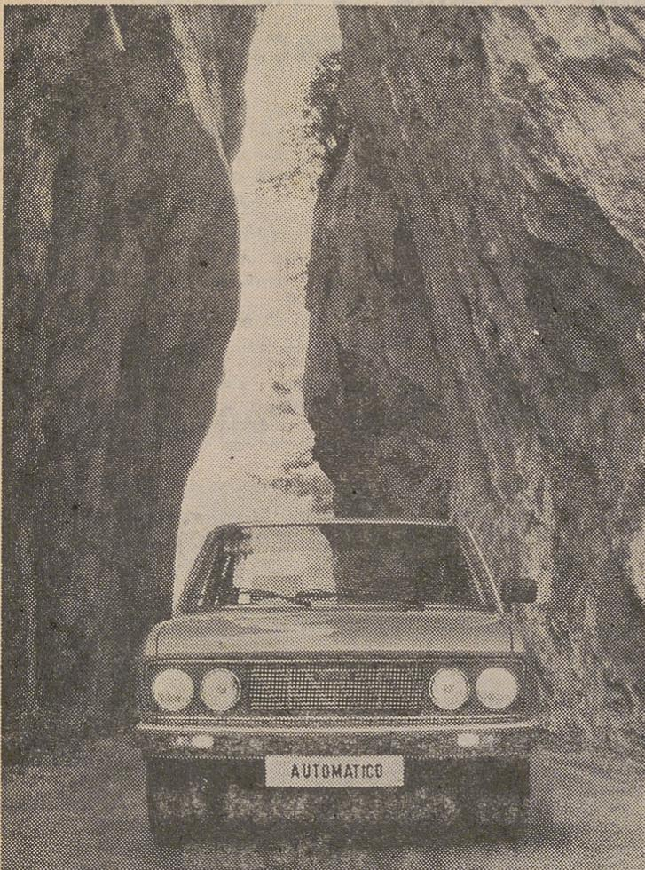
El nuevo SEAT 132 automático, está dotado de un motor de 1.800 c.c. de doble árbol de levas en cabeza, que desarrolla 107 C. V. (Din), con una caja de cambios General Motors, que suprime el embrague y facilita, sensiblemente, la conducción en ciudad.
