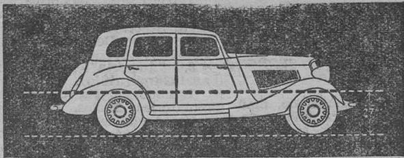
Marcha Nivelada, según se obtiene mediante la Suspensión Quadripoise, es mejorada notablemente por el centro de gravedad sumamente bajo del Studebaker. El coche es más ancho que alto. El centro del peso total del coche está a 68 cms. del suelo. Aún cuando se le inclina a un ángulo de 58 grados, el coche vuelve fácilmente a su posición normal.
