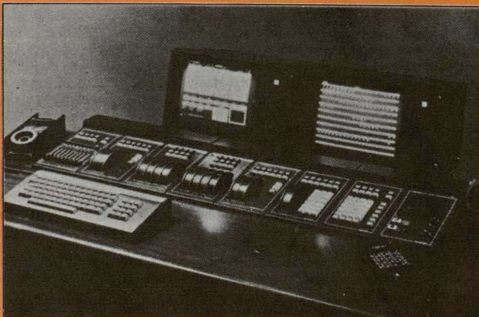
Mesa AVAB, modelo VIKING es su máxima configuración. Controla hasta 1000 canales. Modem para transmisión por línea telefónica. Control por infrarrojos, con módulo sintetizador de voz. Lleva ordenador de 32 bits programado en Pascal.
