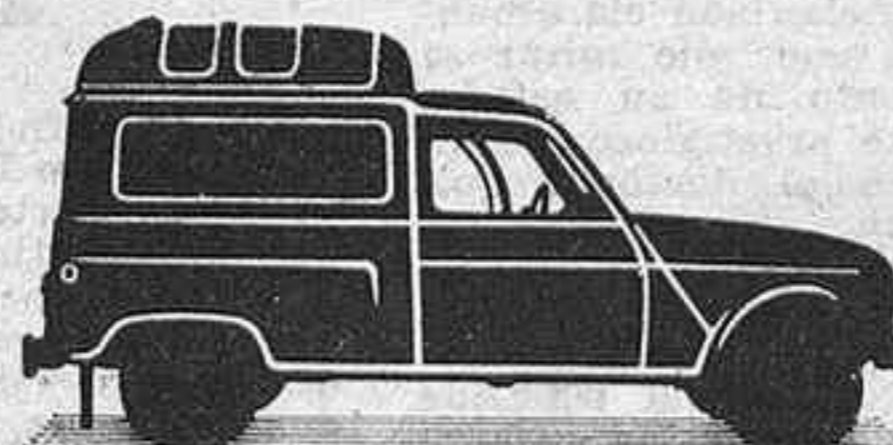
Sobreelevada Carga 425 kg. Altura útil 1,307 m. Volumen útil de carga 2,08 m 3
