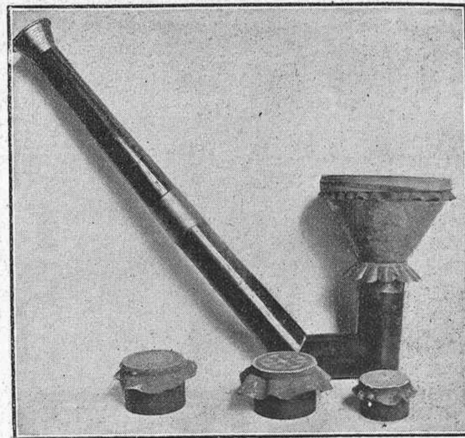
El sencillo é ingenioso aparato llamado eidófono y algunos recipientes, por cuyo medio se registran las vibraciones de la voz.
