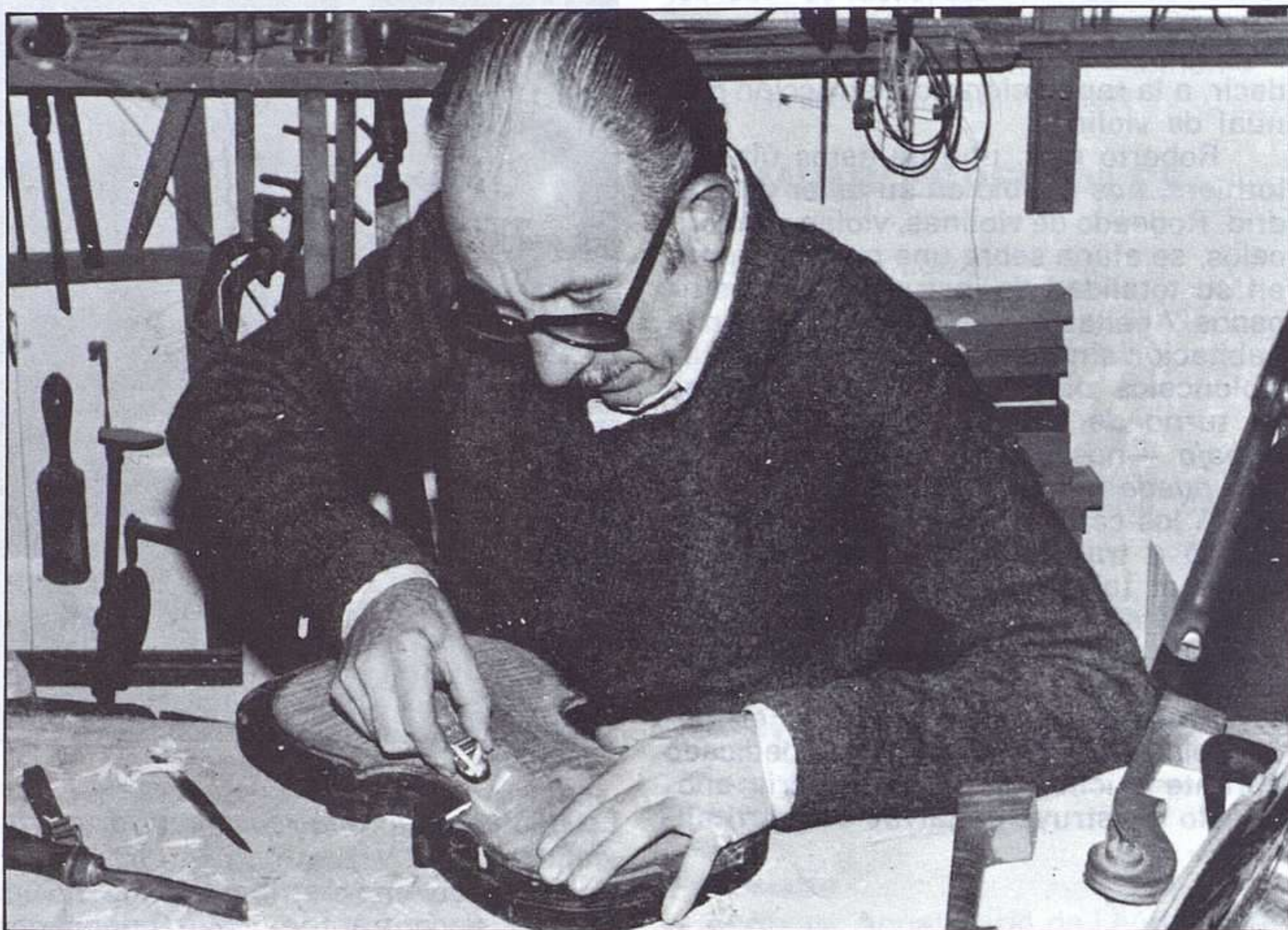
La delicada tarea de desbastar las tapas para obtener el grosor adecuado.
