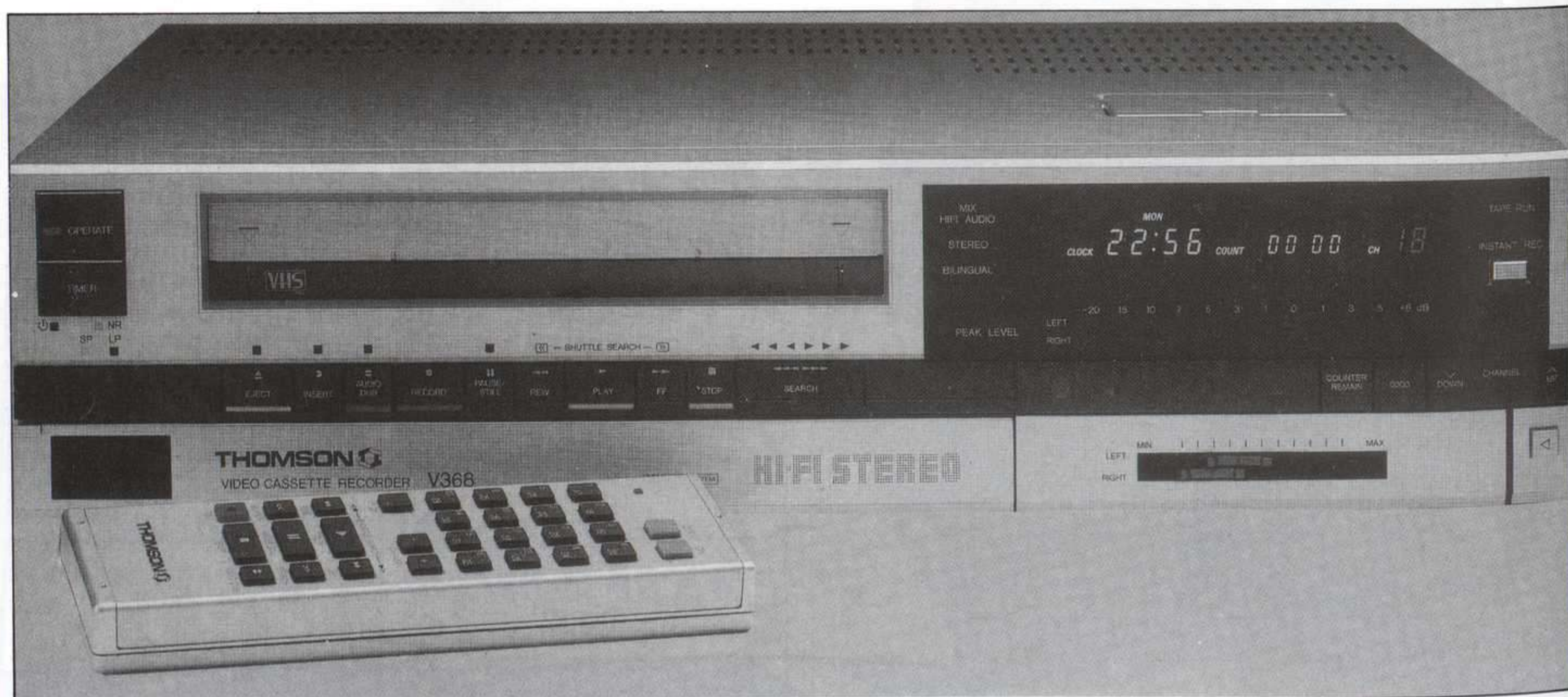
El módulo V 368 y sus equivalentes en otras marcas permitían grabar en estéreo-bilingüe tanto en las pistas HI-FI como en las normales. Fue uno de los más completos de su época.
