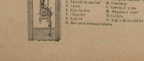
A. Bomba B. Válvula de desahogo C. Válvula de succion D. Curva E. Caja de aire F. Chupador G. Tubería H. Baos para sostener tubería
