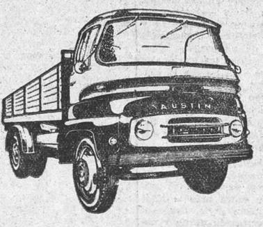
Motor BMC Diesel 6 cilindros 107 CV. y Volquete para 4 m.<sup>3</sup>
