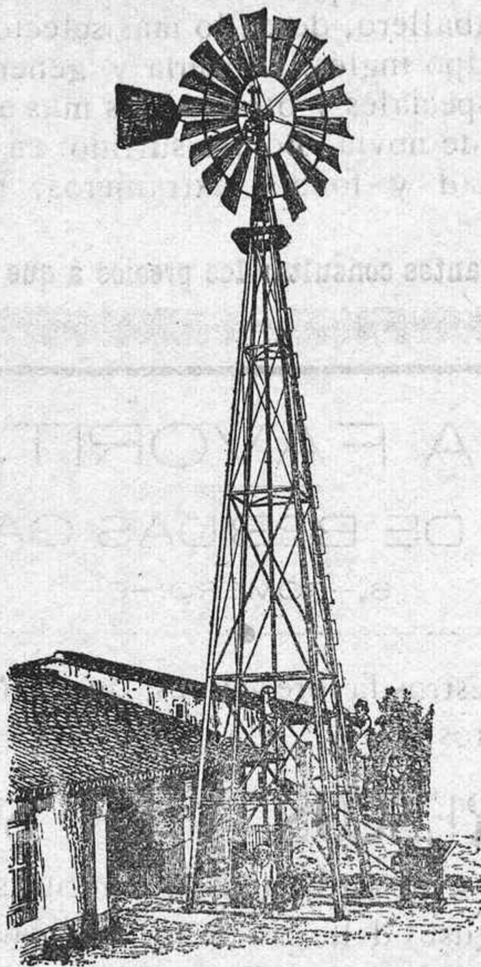
Los de mayor potencia y provistos de dos bombas que operan por medio de balancines, pueden elevar grandes cantidades de agua habiéndose dado el caso de que con un motor de 16 pies se han sacado de un río hasta 80.000 litros por hora, cerca de 2.000 metros cúbicos por día. Con un buen estanque que embalse el agua que pueda sacarse aprovechando todos los vientos, se hace fértil el más árido desierto y puede asegurarse no hay empresa más productiva con relación á su costo.
