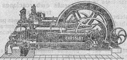
Sencillos y económicos, Para accionar dinamos, bombas, molinos, etc. GASOGENOS patentados para gasificar toda clase de combustibles. Fídase detalles y presupuestos directamente á la casa constructora.
